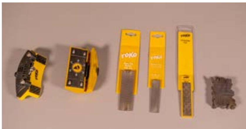
➤ **Abbildung 1:** Neben der Skihalterung braucht's ein Kantenschleifer mit einstellbarem Schleifwinkel, eine grobe Base-Feile, eine Standard- und eine Diamantfeile sowie einen Schleifgummi und – eventuell (ganz links) – einen Seitenwangenabzieher.
