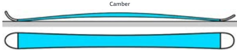
Abb. 2: Full Camber: Diese Bauweise war über Jahre das klassische Skiprofil: Die Vorspannung (Camber) des Skis reicht von der Skispitze (Tip) bis zum Skiende (Tail).
