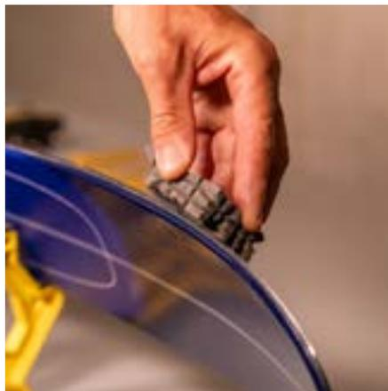
➤ **Abbildung 6:** Mit dem Schleifgummi wird die Kante an der Schaufel und am Ende gebrochen, um ein Verschneiden des Skis im Schnee zu verhindern.
