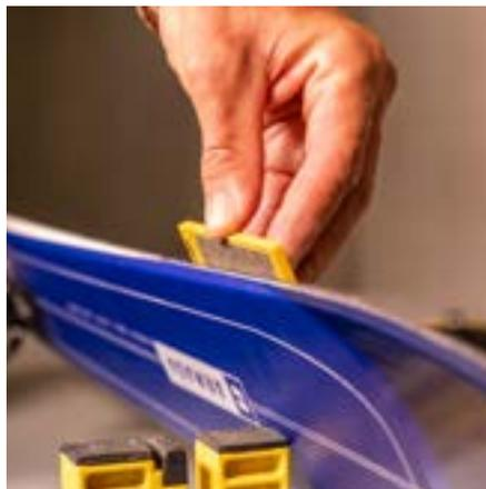
➤ **Abbildung 5:** Mit der Diamantfeile entfernen wir den durchs Schärfen entstandenen Grat.
