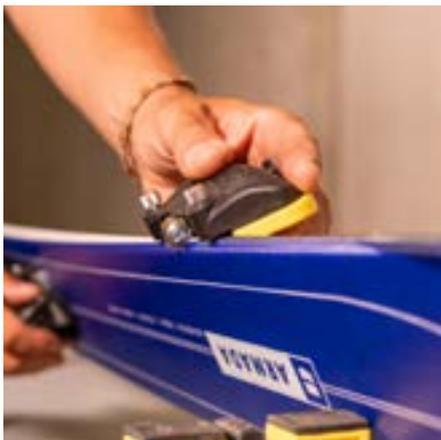
➤ **Abbildung 4:** Ist die Skikante so weit abgeschliffen, dass die Feile nicht mehr richtig beißt, müssen wir mit dem Seitenwangenabzieher Material abtragen.
