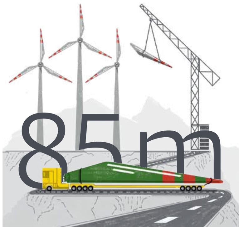
Die Errichtung von Windkraftanlagen bedeutet einen signifikanten logistischen Aufwand: Um etwa ein 85 m großes Rotorblatt zu transportieren, braucht es ganzjährig befahrbare, breite, schwerlasttaugliche Zufahrtsstraßen.
